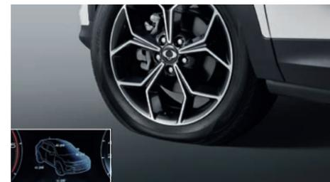
Система контроля давления воздуха в шинах (TPMS)
