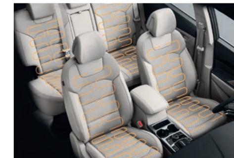
Функция вентиляции сидений с трехступенчатой регулировкой
