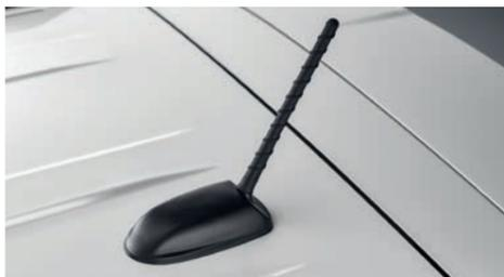
Антенна в задней части крыши
