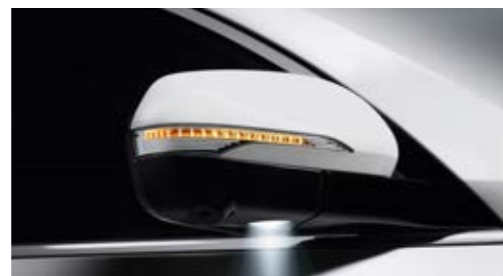
Повторители указателей поворота и лампы подсветки околodверного пространства в корпусах зеркал заднего вида
